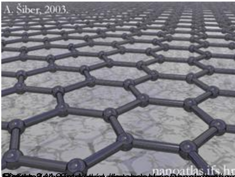
Figura 3.44. Grafeno: una lámina de un átomo de espesor formada por una red de átomos de carbono en estructura hexagonal.
