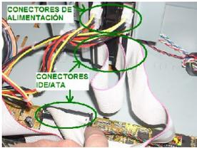
En el ejemplo mostrado tenemos una placa con dos puertos IDE. Vemos dos discos duros sobre el mismo bus IDE/ATA, uno configurado como maestro y otro como esclavo (jumper blanco configurado en el dispositivo esclavo, jumper negro configurado en el dispositivo maestro) y una unidad lectora de cd en el segundo canal IDE.
