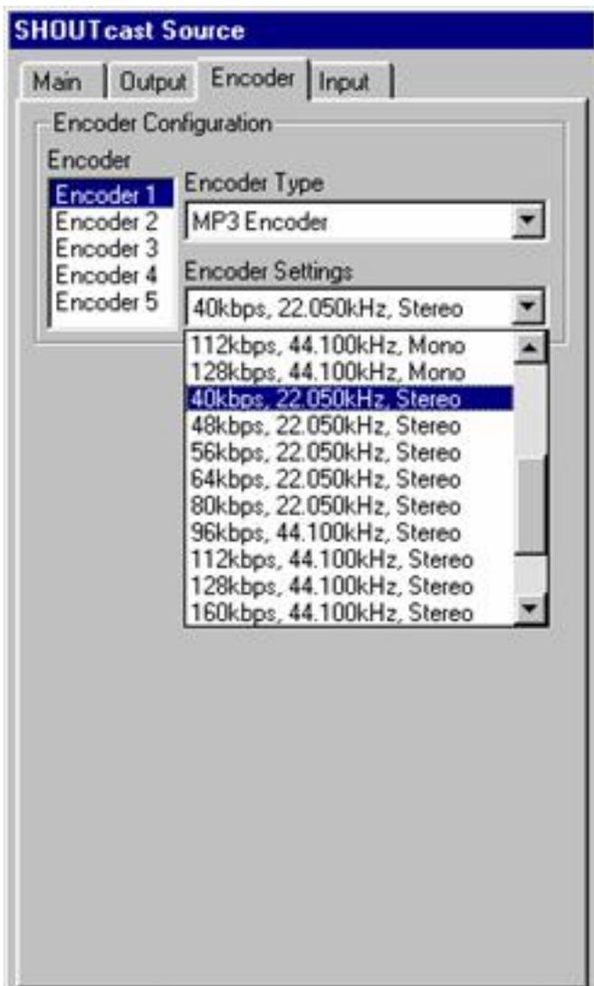
entonces cambiamos la pestaña de Encoder, seleccionamos Encoder1 con Encoder
