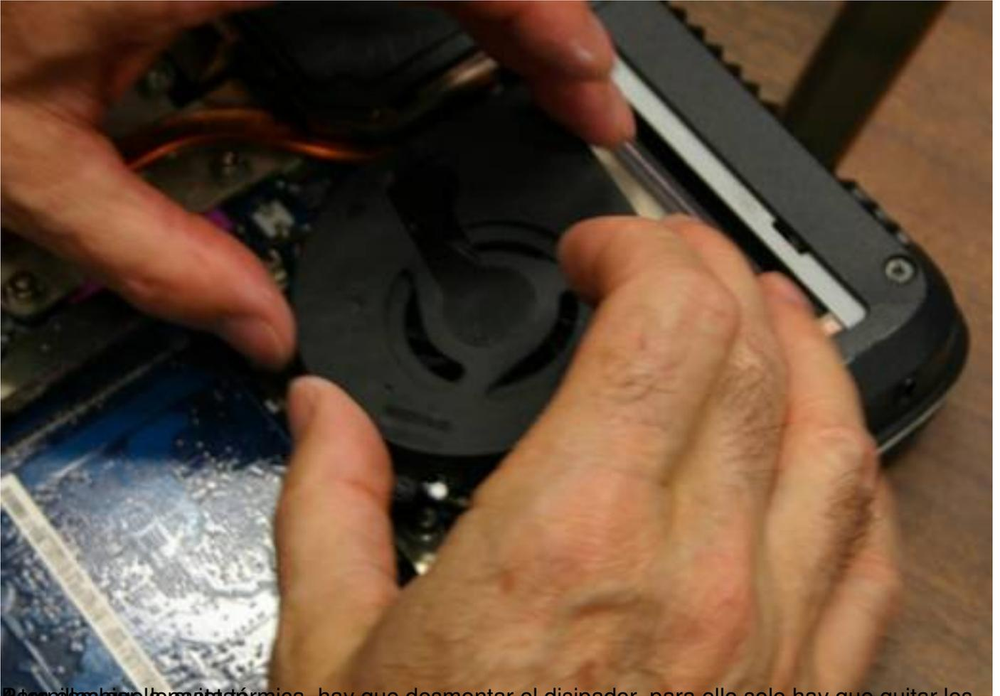
Para cambiar la pasta térmica, hay que desmontar el disipador, para ello solo hay que quitar los
