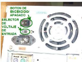
Para cambiar la fuente de alimentación primero tenemos que desconectar de cada dispositivo interno (disco duro, lector de cd/dvd, etc.) los cables de alimentación.
