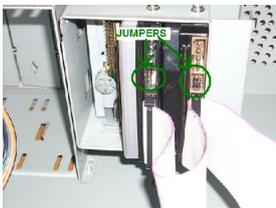
Para saber cómo se ha de colocar el jumper para que un disco duro sea maestro o esclavo basta con mirar la información que viene impresa sobre el disco.
