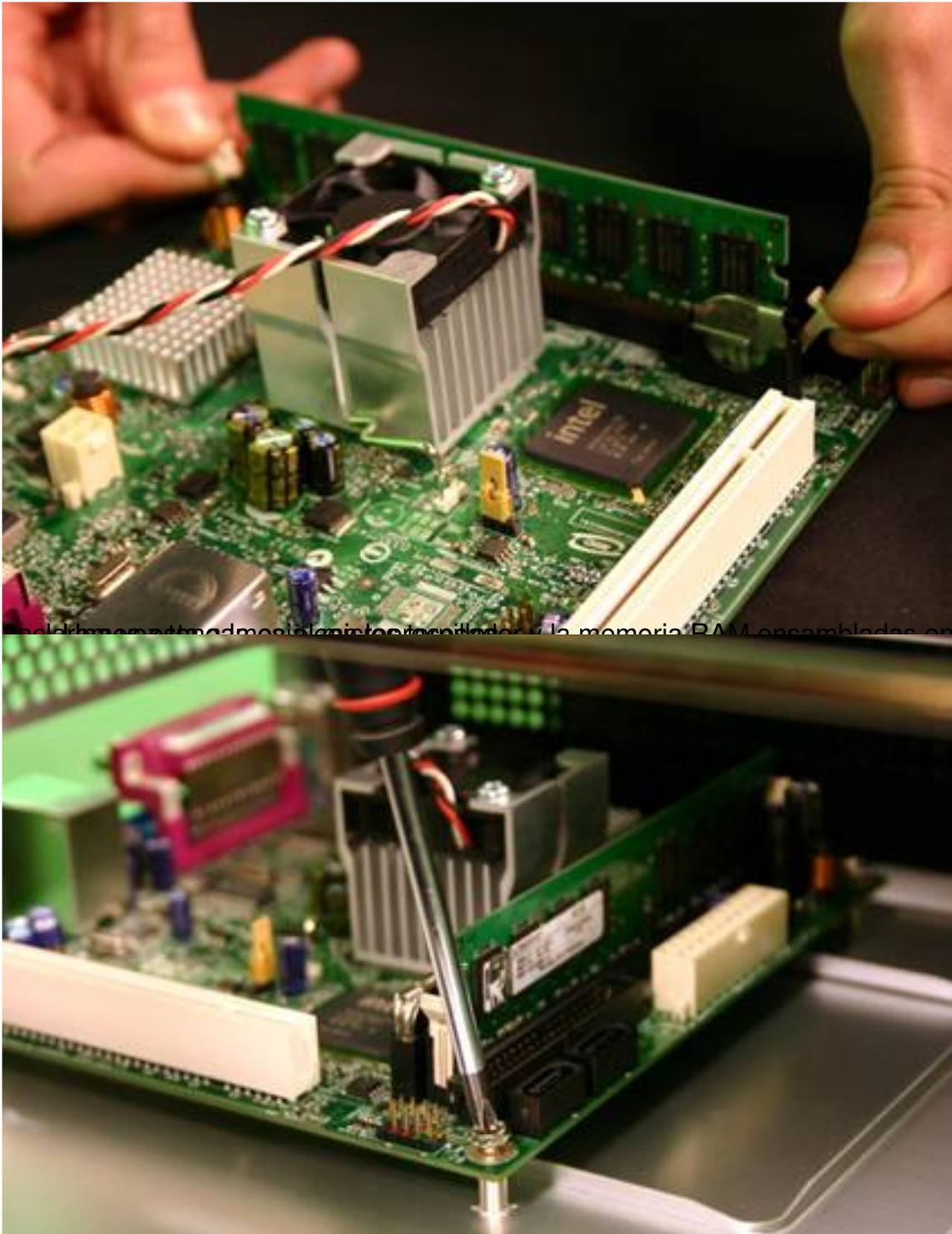
En el primer paso se conectan el interruptor de potencia y la memoria RAM ensamblados en la placa base,
