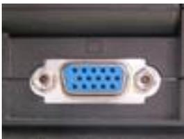
Se trata de un conector de 15 pines que se utiliza generalmente para interconectar un ordenador con un monitor. Aunque dan una calidad suficiente para un monitor CRT, suelen quedarse cortos cuando hablamos de pantallas TFT LCD o similar. Esto es debido a que los datos del ordenador, digitales, han de convertirse a formato analógico, transmitirse por el cable y volver a convertirse a digital para ser presentados en la pantalla, como indica la siguiente figura:
