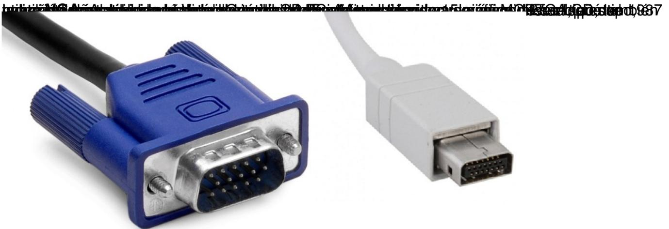
Detalle de conectores VGA y Mini-VGA
