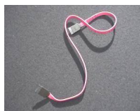
Fig 12. Cable de datos Serial ATA.
