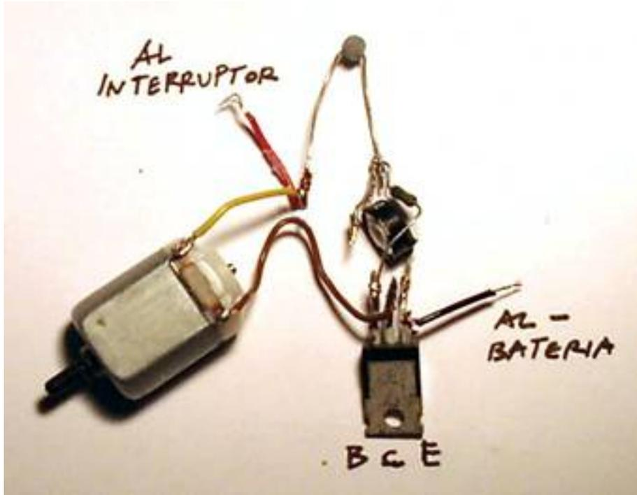
El punto de partida es la conexión de los elementos electrónicos que accionan cada motor por separado, ya que en este caso la configuración de ambos circuitos no es en paralelo compartiendo la batería, sino que serán independientes y el cuerpo del insectoide estará formado por dos portapilas de 3 V superpuestos.
