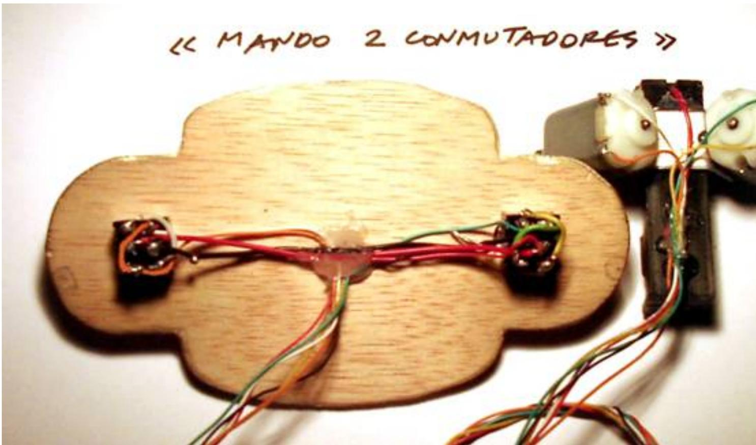
En los mandos que he construido utilizo conmutadores dobles de tres posiciones (tanto de tipo palanca como de corredera), utilizando la posición intermedia para detener el motor correspondiente. Empleo componentes comerciales en mis proyectos con los alumnos, ya que aparte de su fiabilidad, los puedo reciclar casi todos para el curso siguiente; además su
