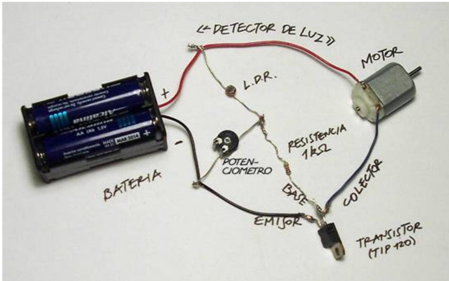
Para el montaje de este robot-bicho se utiliza un solo portapilas de 3V, de modo que la corriente suministrada por la batería será compartida para activar los circuitos electrónicos de ambos motores en una configuración en paralelo y a través de un conmutador simple. El proceso de preparación y conexión de los componentes es similar al del ejemplo termotrópico, empleando ahora un potenciómetro de 4,7 Kohmios.
