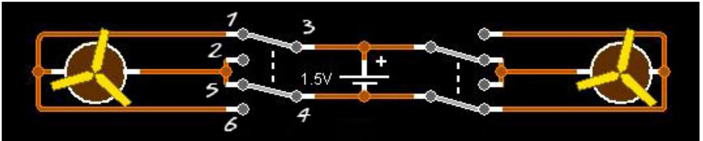
Los cables rojo y negro correspondientes a los polos de la pila se conectan en los bornes centrales de cada conmutador (números 3 y 4) y se extienden de uno a otro, ya que ambos motores de nuestro móvil comparten la pila con una disposición eléctrica en paralelo. Cerradas todas las conexiones, y antes de su posible soldadura, conviene comprobar si el insectoide se desplaza en sentido de avance o retroceso moviendo las palancas o correderas de los dos conmutadores en sintonía.
