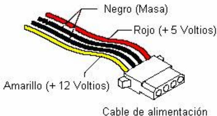
~~pin 1 (+12V) amarillo, pin 2 (Masa) negro, pin 3 (Masa) negro, pin 4 (+5V) rojo. El conector SATA también tiene un pin 5 (+5V) rojo.~~
