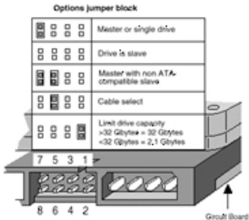
Como el disco duro a instalar va a ser Maestro (sin ningún esclavo) podremos seleccionar:
