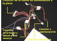
Fig 9. Conectores de la fuente a la placa
