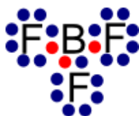
El boro solo tiene 6 electrones en su última capa. OCTETE REDUCIDO O INCOMPLETO
