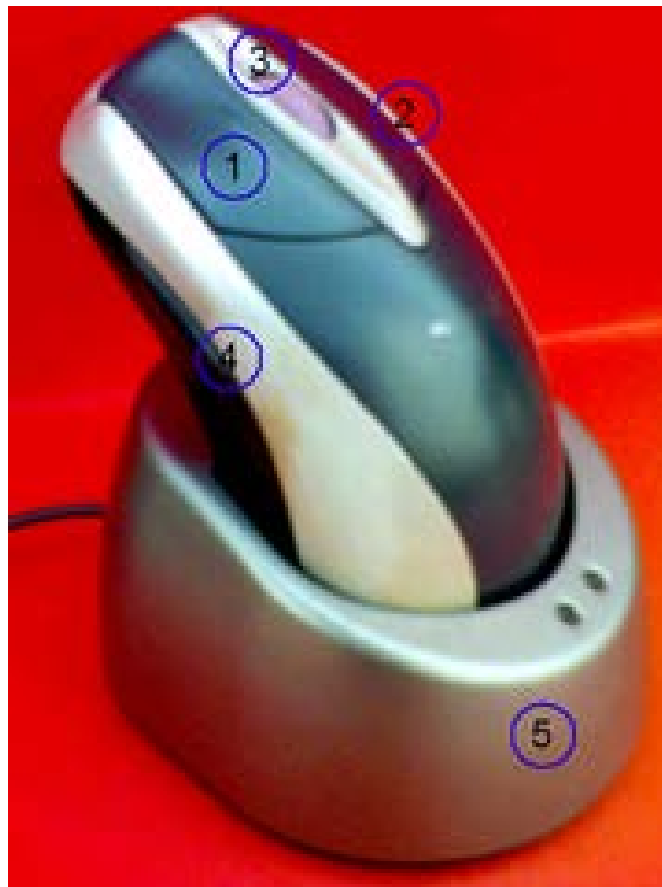
Un modelo inalámbrico con rueda y cuatro botones, y la base receptora de la señal
