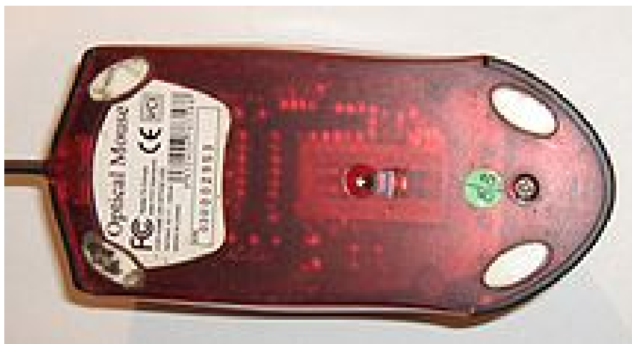
Parte inferior de un ratón con cable y sensor óptico
